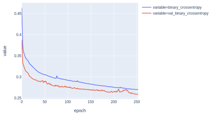
Σχήμα 6.10: Απεικόνιση της εξέλιξης της συνάρτησης κόστους για την εκπαίδευση του autoencoder. Η χαμηλότερη τιμή της συνάρτησης κόστους στο σύνολο δοκιμής ήταν 0.25898.
